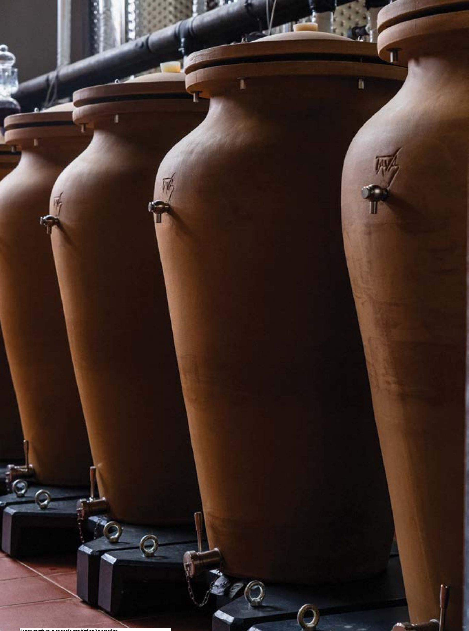
Οι τσιμεντένιοι αμφορείς στο Κτήμα Ζαφειράκη.
